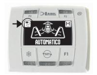
Visualización del testigo de alimentación La presencia del símbolo significa que existe tensión de alimentación de red y la batería, si está presente, funciona.
