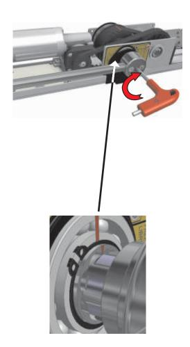
Desplace el tornillo de bloqueo del muelle de la posición bloqueada a la posición libre.
